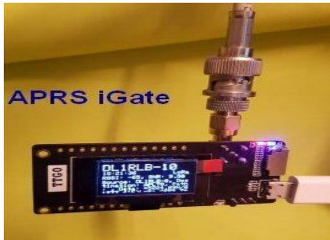
El **iGate/LoRa** es una placa de desarrollo con un modem **LoRa**. Se le instala un firmware específico para trabajar como receptor. Este equipo debe de estar conectado a internet para subir a la red de redes todos los paquetes que reciba.
